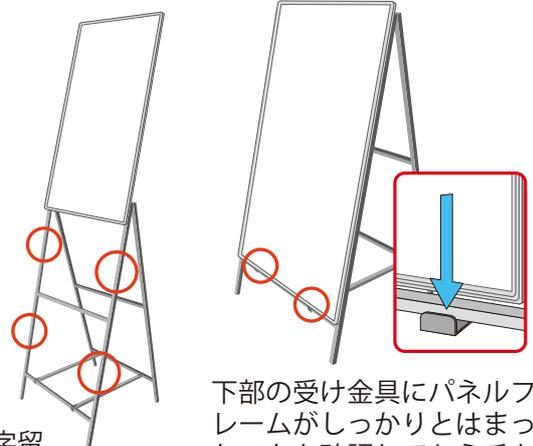
下部の受け金具にパネルフレームがしっかりとハマったことを確認してから手を離してください。2面にパネルをセットする場合も同様にセットします。
