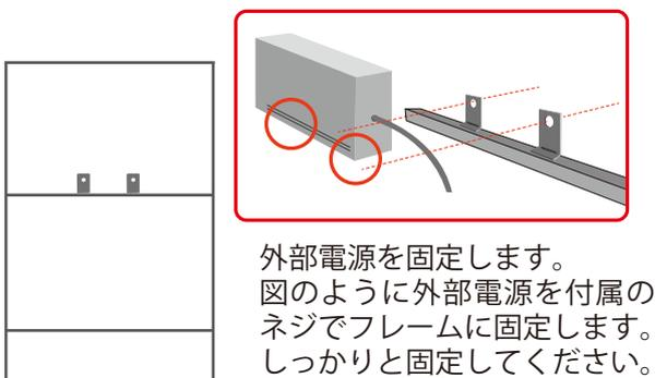
外部電源を固定します。図のように外部電源を付属のネジでフレームに固定します。しっかりと固定してください。
